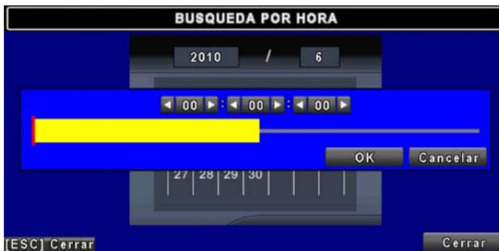
Haga clic en la fecha para mostrar la hora de grabación de esa fecha específica con la barra de tiempo. Puede cambiar la hora (hora/ minuto/ segundos) o hacer clic en una hora específica de la barra de tiempo con el ratón y después pulse “OK”. El DVR reproducirá los datos grabados seleccionados.
