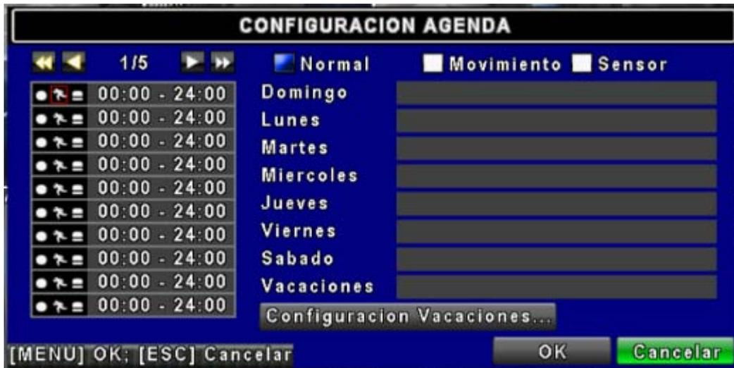
Además de la grabación manual, puede también configurar el horario de grabación por semanas y un programador de grabación: Grabación normal, detección de movimiento y detección de sensor.
