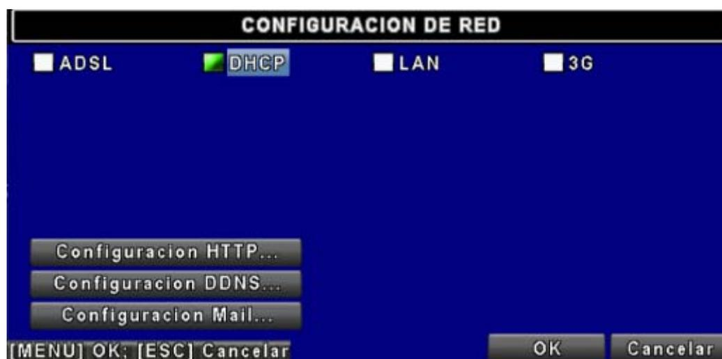
Si se utiliza la opción de DHCP para la conexión a la red del DVR, el servidor DHCP asignará una dirección IP automáticamente.
