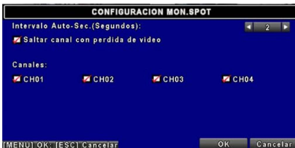
El DVR tiene dos modos de salida de vídeo; una es la salida de vídeo principal y la otra es la salida de vídeo para un segundo monitor (SPOT). Esta opción permite controlar el orden de los canales para verlos secuenciales en el modo SPOT. El usuario puede monitorizar cada canal en el modo SPOT.
