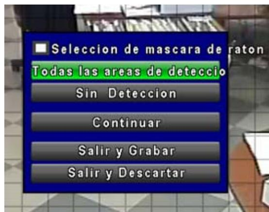
Hay 22x15 particiones en el área de detección de movimiento. Por defecto, el área de detección de movimiento es toda la pantalla. La detección está activada en las cuadrículas rojas y no activada en la zona transparente.
